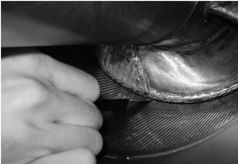
Abb. 13-17: Messung des Arbeitsspalt zwischen Sieb und Schnecke, gemessen wird an der Unterseite des Siebes bei Stillstand der Maschine, die Messung ergibt den 2-fachen Arbeitsspalt, da im ruhenden Zustand das Sieb oben auf der Schnecke aufliegt.
