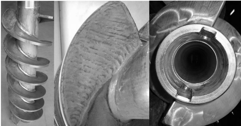
Abb.13-14: Schnecke mit gepanzertem Spezialwerkstoff und Nabenaufnahme, Neuzustand
