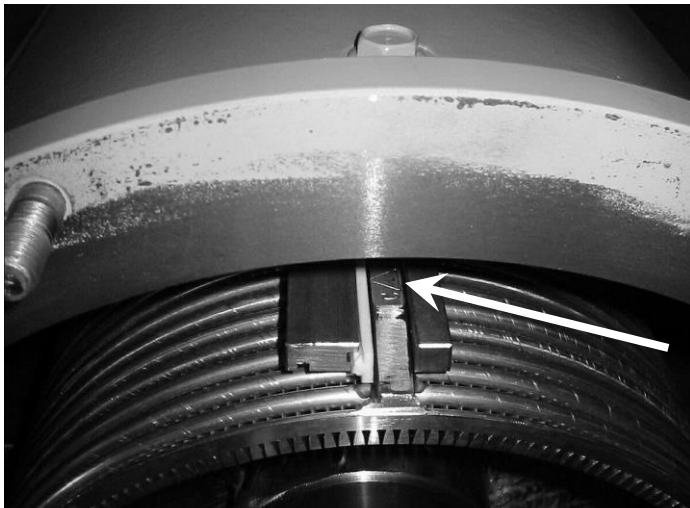
Abb.13-12 Einbauposition des Siebes, eingeschlagenes Dreieck oben und nach vorn zum Separator
